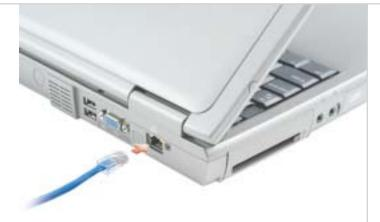
**Network (Back of Computer)** 网络(计算机背面) ネットワーク(コンピュータの背面)
